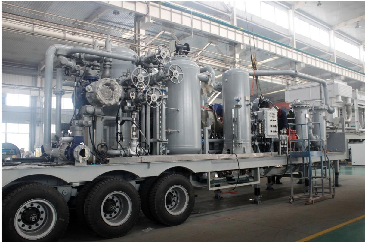
Благодаря своему многолетнему опыту компания Jereh спроектировала оборудование в соответствии с условиями заказчика - эксплуатация в условиях низких температур, состав тяжёлых углеводородных газов, диапазон изменений потока воздуха.
